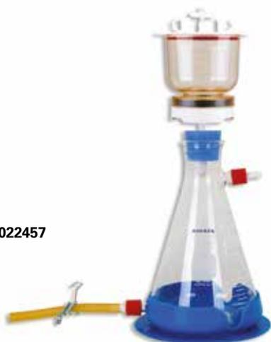
**1022457Set Equipo completo de filtración con filtros PES MF31**
